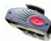
Alarm dla pracujących w pojedynkę
